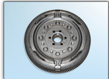
Bild 7: Motorseite ohne Vertiefung beim Sachs ZMS
