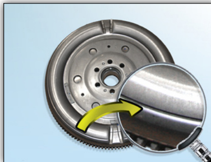
Bild 6: Motorseite mit umlaufender Vertiefung beim LuK ZMS
