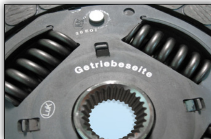
Bild 1-4: mögliche Beschriftungen auf der Kupplungsscheibe
