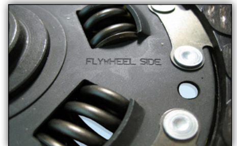
Bild 1-4: mögliche Beschriftungen auf der Kupplungsscheibe
